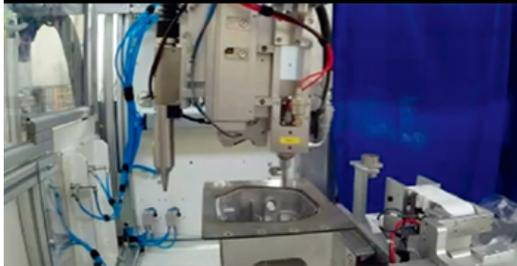
Su ogni particolare, il robot rileva con un sensore laser montato sul polso le specifiche tecniche del pezzo e, in base alle quote di quattro punti di misura, esegue i movimenti necessari.
