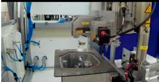
Il sistema Keyence ha permesso di ottenere il posizionamento in continuo e di controllare le tre dimensioni del cordolo in tempo reale.
